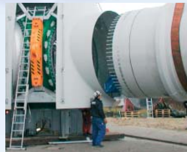
oben: Montage eines Rotorflügels an der Multibrid M5000
